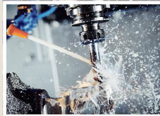
Oberflächengüte der Werkstücke und einen guten Korrosionsschutz. Außerdem entspricht er der TRGS 611 und ist formaldehydfrei.
